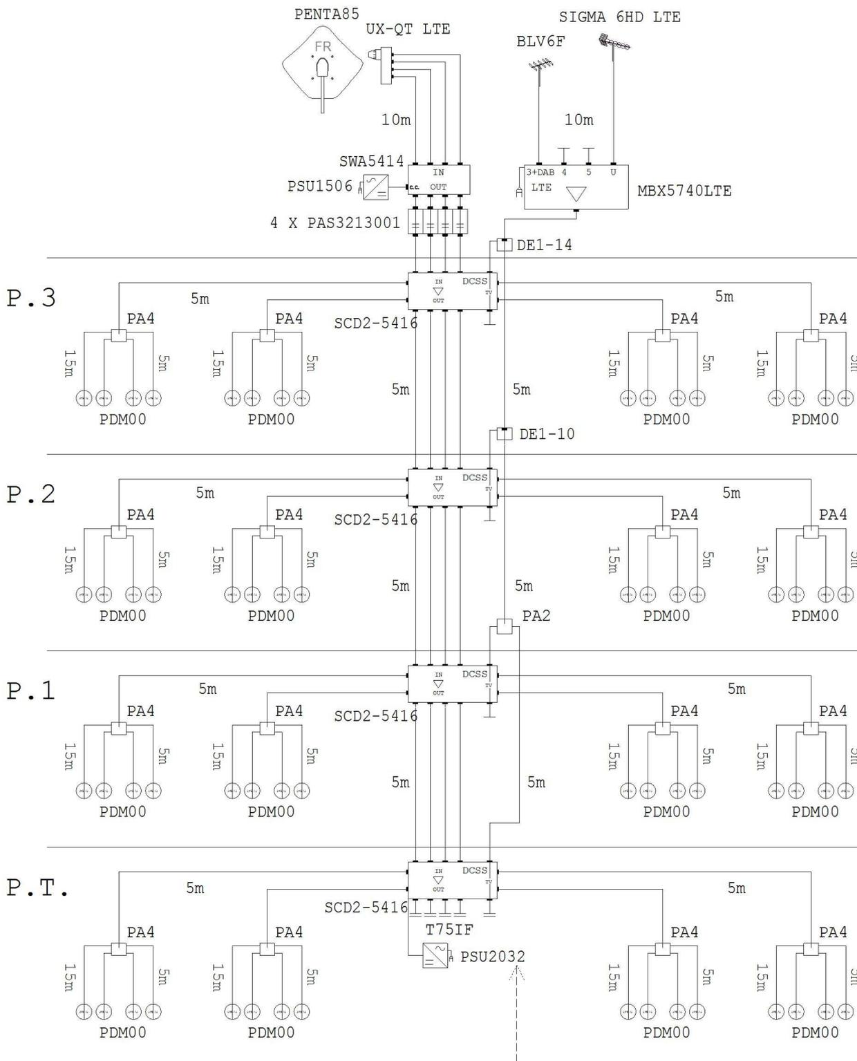
L'indicazione delle antenne, dei supporti porta-antenna e dei preamplificatori da palo nello schema è puramente indicativa, in quanto la scelta dipende esclusivamente dalla tipologia di segnale TV ricevuto nella zona di realizzazione dell'impianto e dalla struttura dello stabile. Il presente schema di massima proposto non costituisce progetto che deve essere redatto da progettista abilitato.
